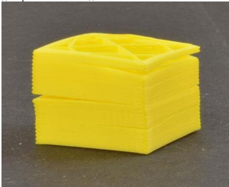
Рисунок 4.6 – Приклад проблеми, коли шари розділяються і розщеплюються
