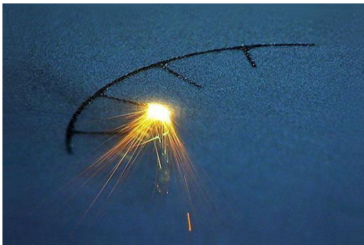
Рисунок 2.3 - Плавлення лазером порошкоподібного металу
