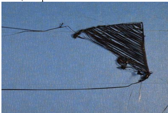
Рисунок 4.2. – Приклад проблеми, коли перші шари не прилипають до платформи 3D-принтера.
