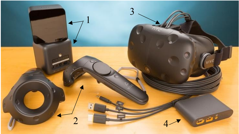
Рисунок 1.1. – Загальний вигляд системи віртуальної реальності HTC Vive, де: 1- базові станції; 2 – контролери; 3- шлем віртуальної реальності HTC Vive; 4 – конвертор, що необхідні для підключення до комп'ютера.
