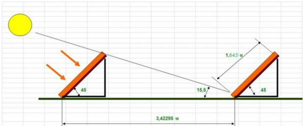
Рисунок 3.5 – Відстань між рядами фото панелей
