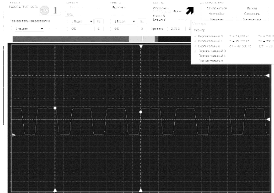
Рисунок 3.4 - Осцилограма роботи системи сканування наявності заземлення
