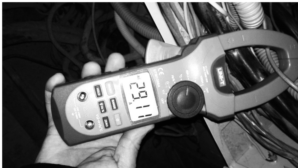
Рисунок 3.5 - Вимірювання споживаного електромобілем струму
