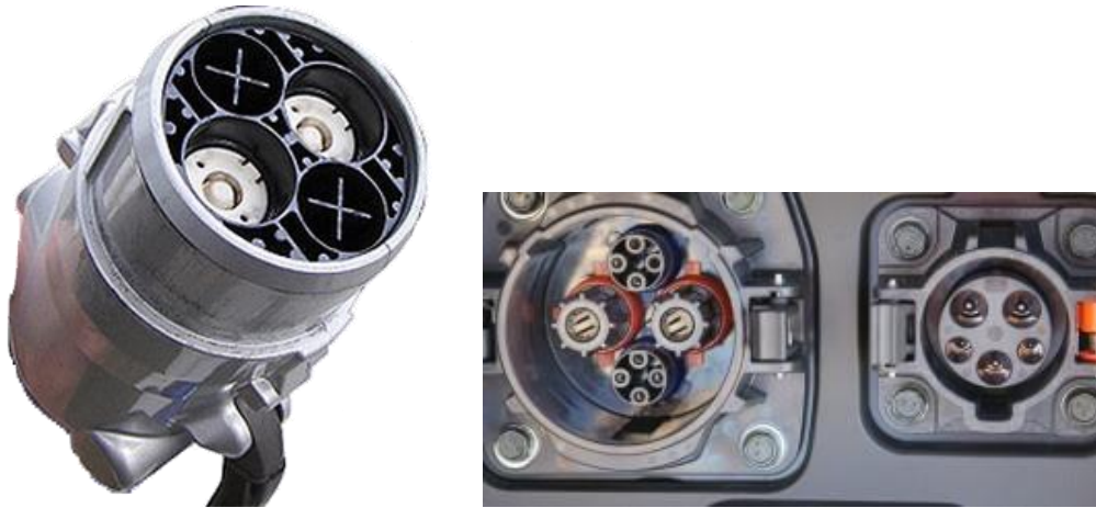
Рисунок 1.2 - Роз'єм Chademo та її монтаж на Nissan
