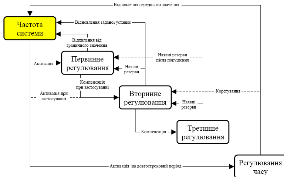
Рисунок 1.1 – Функціональна схема системи регулювання частоти та потужності в енергосистемі
