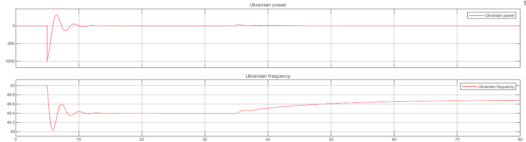
Рисунок Д.1 – Зміна потужності і частоти в ОЕС України при втраті потужності генерації 1000 МВт
