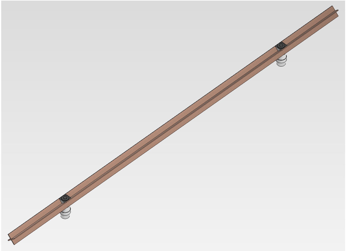
Рисунок 3.5 – Реалістична модель мідної струмопровідної шини з Х-профілем разом зі сталевим кріпленням до фарфорового ізоляторного пристрою
