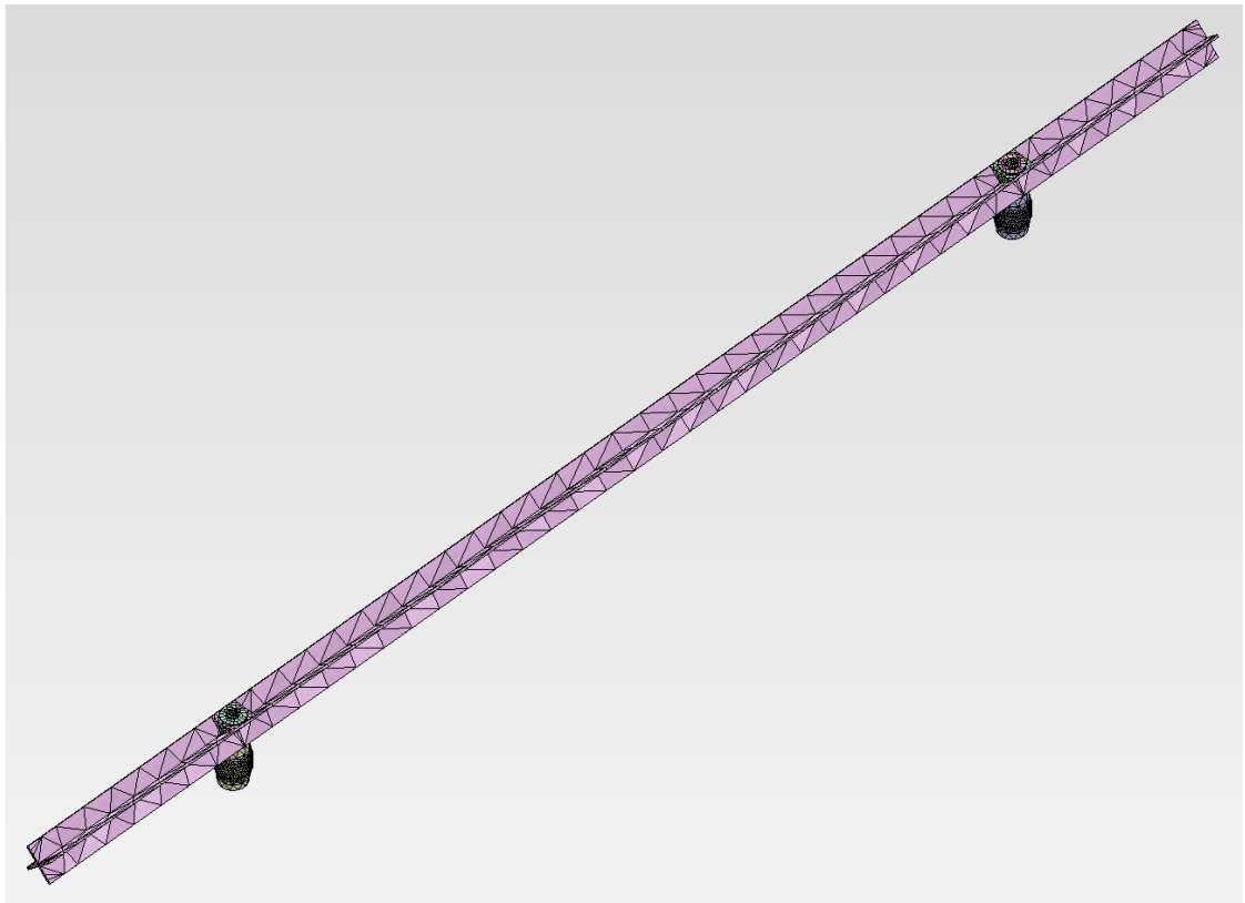
Рисунок 3.3 – Кінцево-елементна модель струмопровідної шини з Х-профілем
